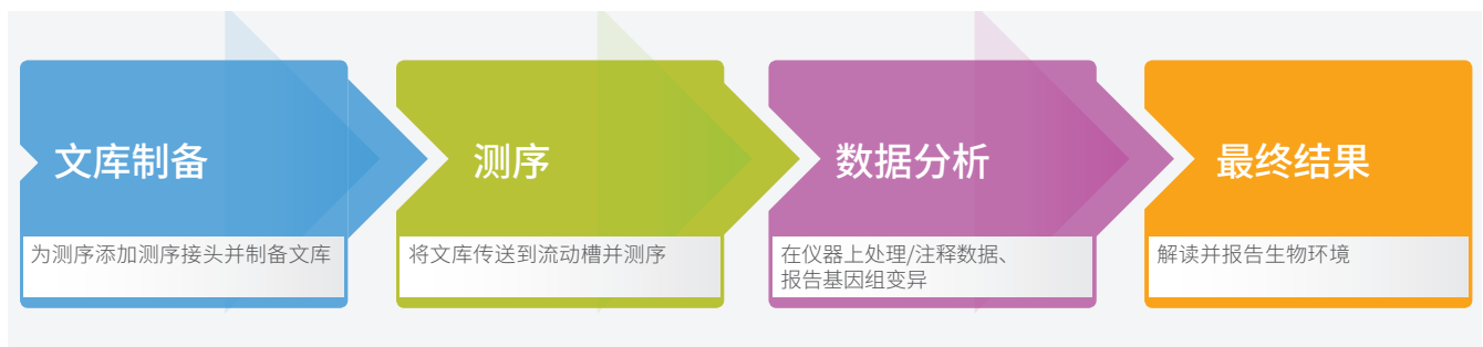
图 2: MiSeq 系统工作流程 — MiSeq 系统的简化工作流程可为新一代桌上测序实现快速的周转时间。可以使用任何兼容的文库制备试剂盒来制备文库。测序时间共五个半小时，包括在使用 MiSeq Control Software 的 MiSeq 系统上运行簇生成、测序、启用了双面扫描 (2 × 25 碱基对) 的评定质量分值碱基检出所花费的时间。
