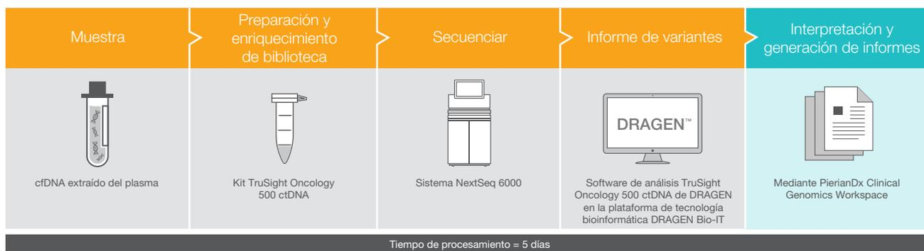
**Figura 2. Flujo de trabajo del ensayo TruSight Oncology 500 ctDNA:** el ensayo TruSight Oncology 500 ctDNA se integra en los flujos de trabajo actuales del laboratorio, permitiendo pasar del cfDNA al informe de variantes en cinco días.
