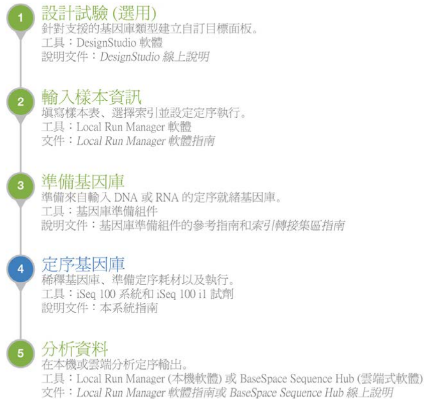
圖 1 採樣到分析工作流程
