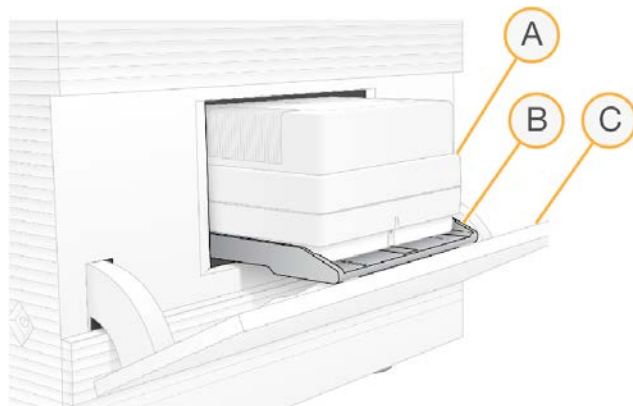
圖 4 已載入耗材室
