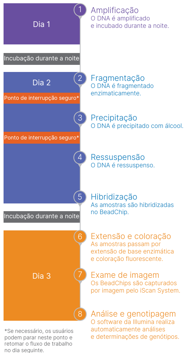
Figura 7: A plataforma Infinium fornece um fluxo de trabalho rápido de três dias com tempo mínimo de manuseio.
