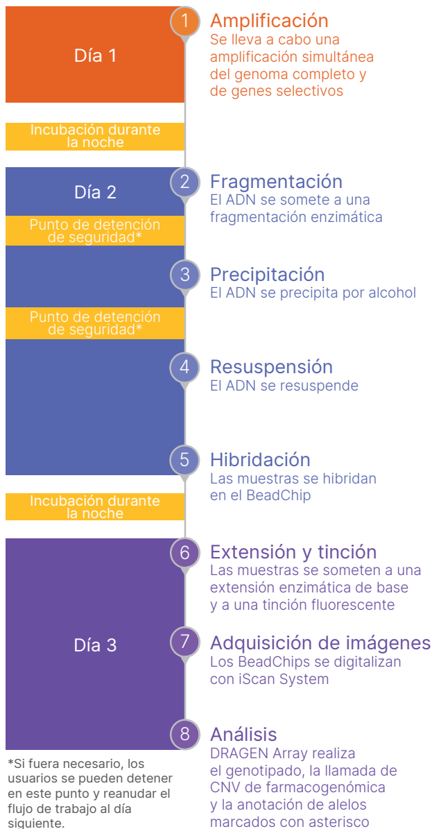
Figura 7: Flujo de trabajo de formato de ocho muestras de Infinium. Un rápido flujo de trabajo de Infinium de tres días con un tiempo de participación activa mínimo.
