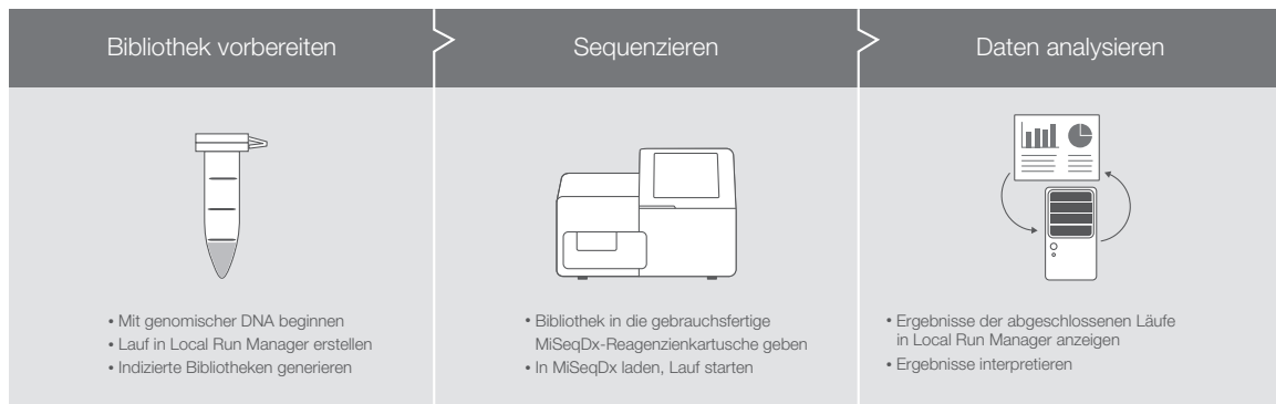
Abbildung 2: MiSeqDx-Assay-Prozess in drei Schritten: Das MiSeqDx-Gerät ist Teil eines integrierten Prozesses, der die Bibliotheksvorbereitung und die Datenanalyse für Assays für die molekulare Diagnostik umfasst. Detaillierte Ergebnisberichte sind nur für Target-spezifische Assays, z. B. das Extended RAS Panel, den TruSight Cystic Fibrosis 139-Variant Assay und den TruSight Cystic Fibrosis Clinical Sequencing Assay, verfügbar.
