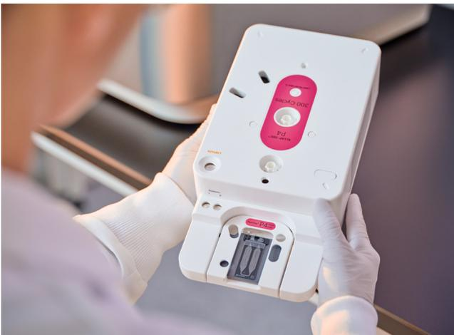
Figura 3: Cartucho de reagente dos sistemas NextSeq 1000 e NextSeq 2000—O cartucho integrado inclui reagentes, fluidos e suporte para resíduos. Basta descongelar e preparar o cartucho de reagente, inserir a lâmina de fluxo, carregar a biblioteca e introduzir o cartucho no instrumento.
