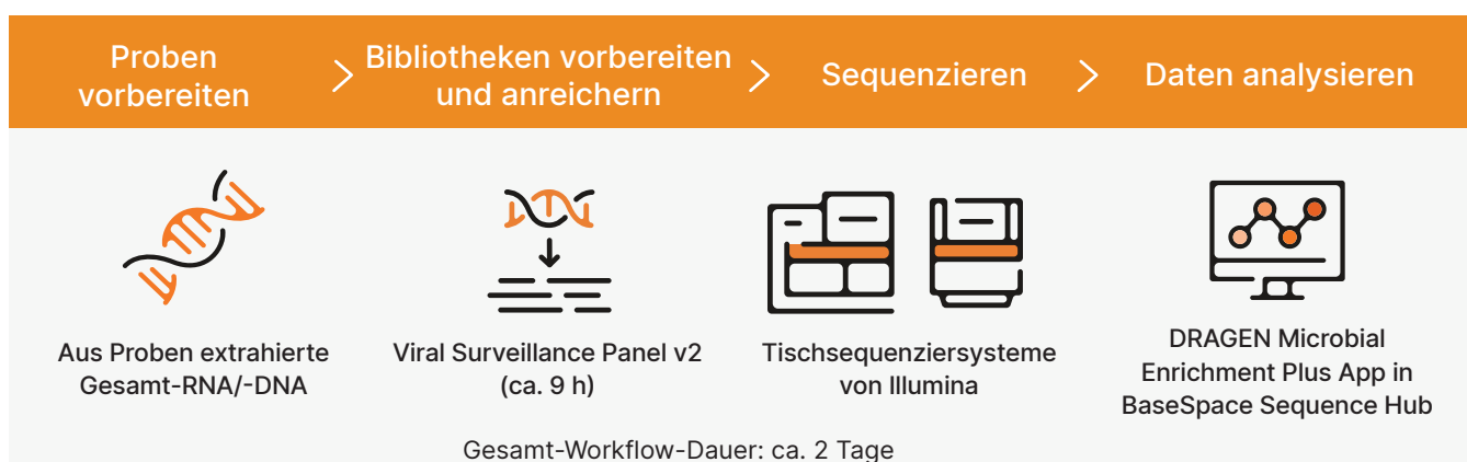
Abbildung 1: Workflow des Viral Surveillance Panel v2: In einem optimierten, umfassenden Workflow werden Bibliotheken aus Umwelt- oder Wirtsproben vorbereitet, auf einem beliebigen Illumina-Sequenziersystem sequenziert und in der DRAGEN Microbial Enrichment Plus App für die Virusbestimmung, die Generierung von Konsensus-Genomsequenzen, das Read-Mapping auf Viren mit der höchsten Übereinstimmung und die Stammtypisierung analysiert. Die Dauer der Sequenzierung ist abhängig von der Proben-Read-Tiefe und dem jeweiligen Sequenziersystem.
